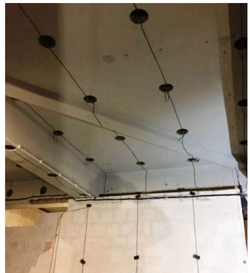
sposób montażu przetworników PIEZO na różnych podłożach
