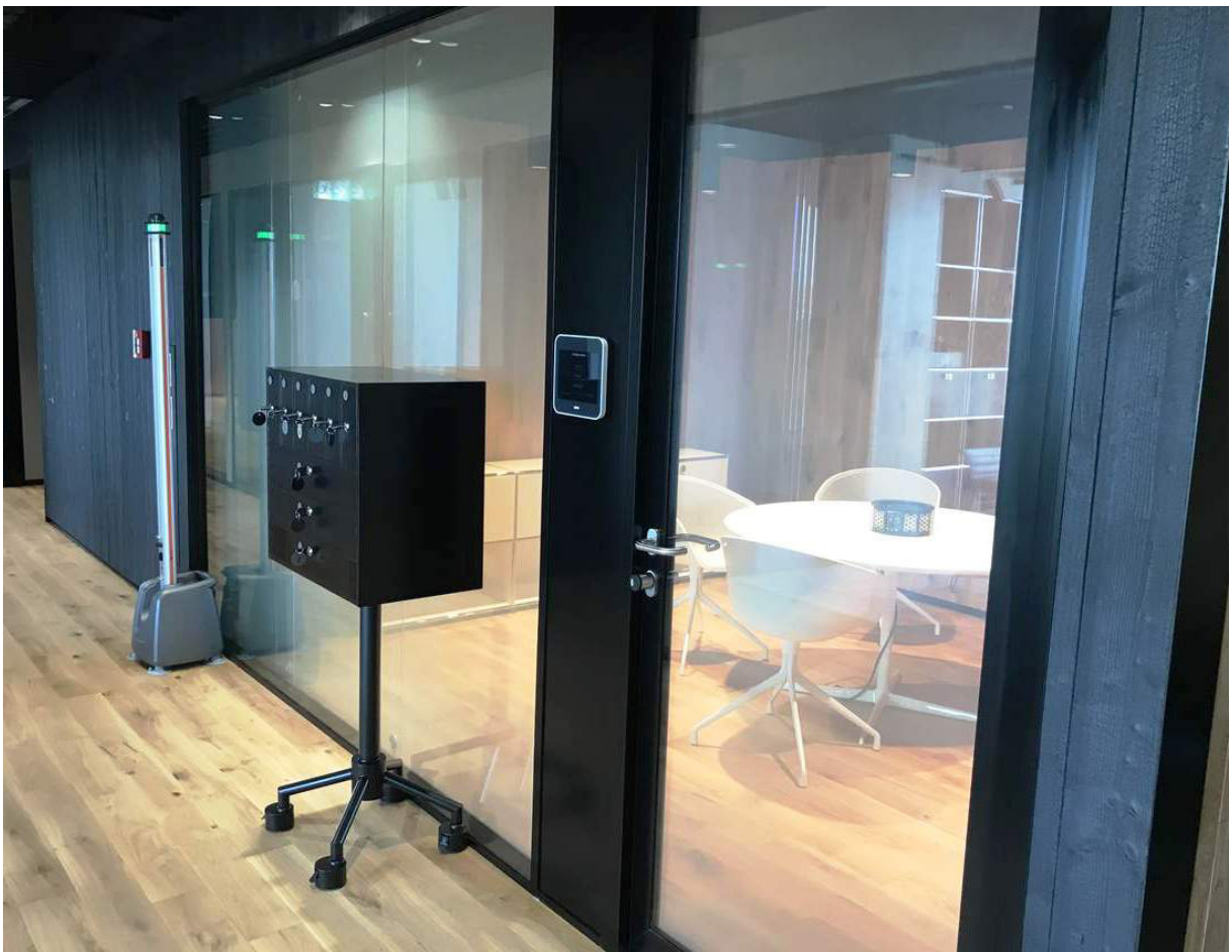
sala konferencyjna - zewnętrzna przenośna strefa depozytu i kontroli z mobilnym depozytorem i detektorem FG
