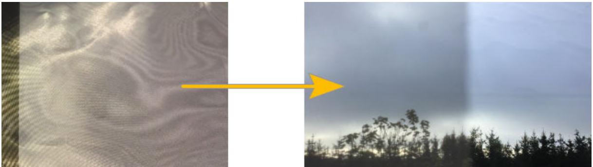
szyba zabezpieczona włókniną z siatki niklowej
