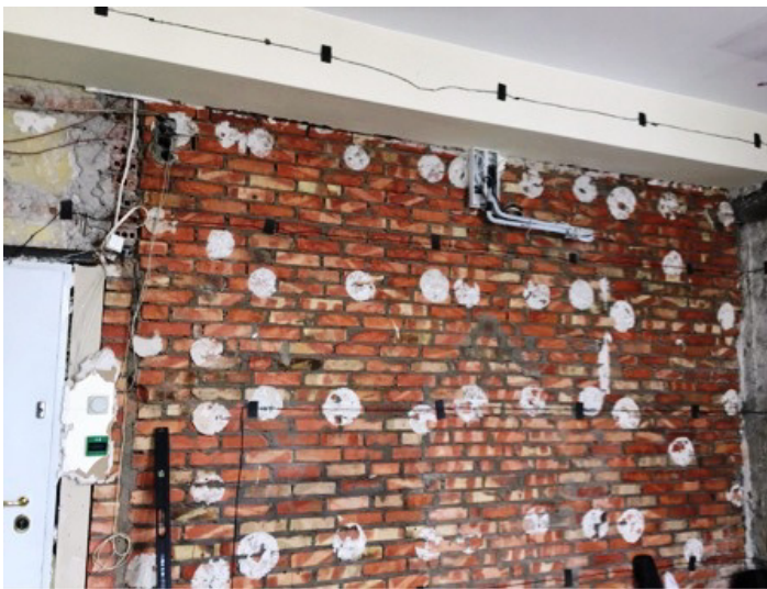
sposób montażu przetworników PIEZO na różnych podłożach
