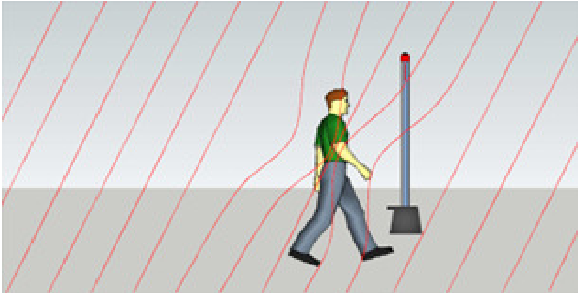
detektor FG - zasada działania
