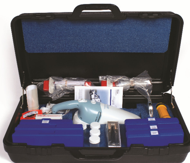
пример комплекта для изъятия микроследов вакуумным методом
